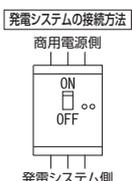
太陽光発電システムなどで使用する遮断器の定格電流不要動作を避けるため、最大負荷電流が遮断器の定格電流の80%以下となるようにご使用ください。(詳細はD-44ページ)
