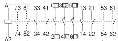
補助接点4a4bの場合この接点が追加されます。なお追加補助接点だけの別売りもしており、ワンタッチで取付できます。
