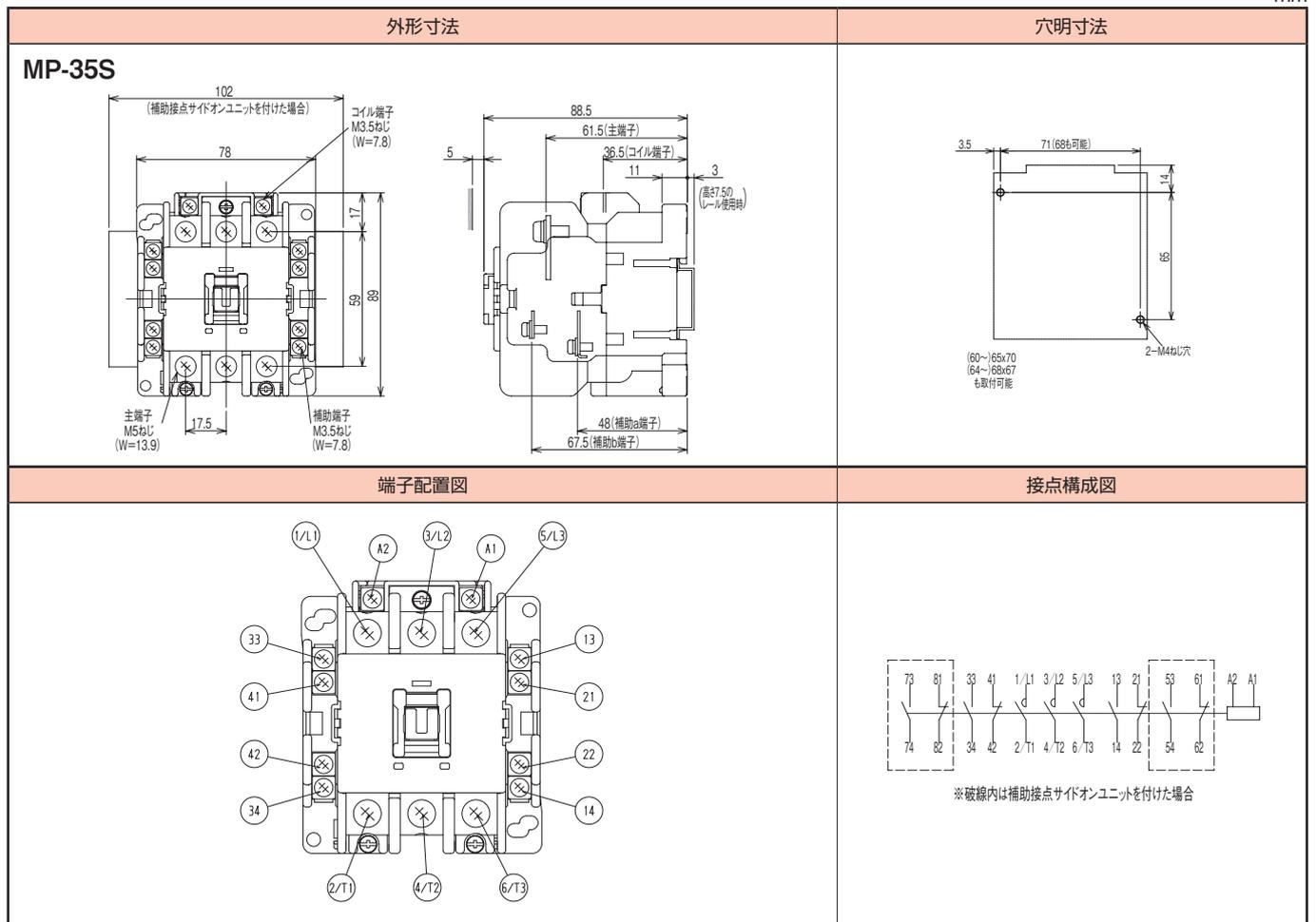
(W= )は使用可能圧着端子最大幅を示します。
