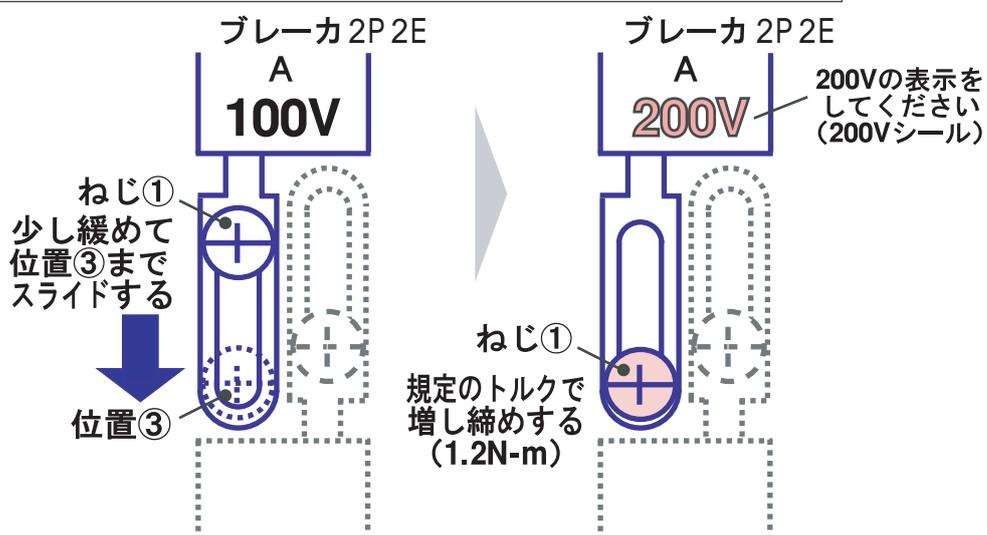
下列のブレーカ B を100V 回路から200V 回路に切り替える方法
